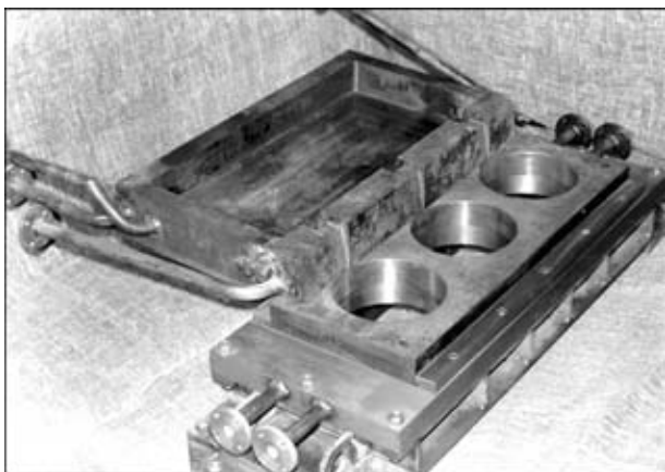
Рис. 2. Технологическая оснастка для одновременной плавки нескольких слитков
