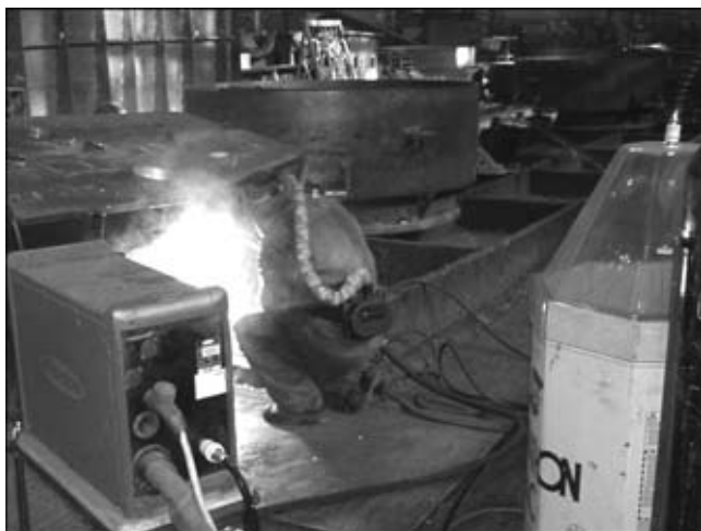
Рис. 1. Сварка металлоконструкции полуавтоматом «нового поколения» фирмы «Fronius» с использованием кассеты повышенной емкости типа «Marathon» (масса сварочной проволоки 475 кг)
