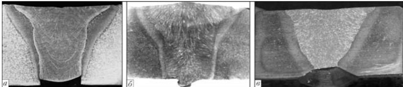
Рис. 5. Макрошлифы отверстий, заваренных под флюсом при сварке на медной (а, б) и флюсомедной (в) подкладке
