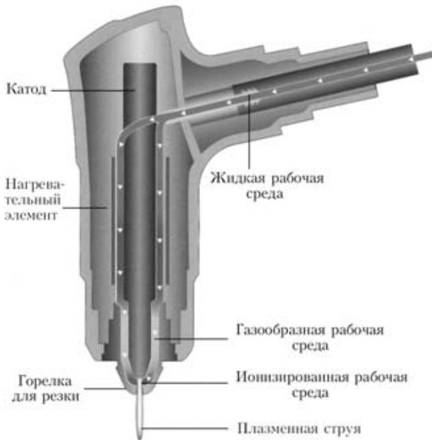
то и другое в значительной степени ограничивает портативность и усложняет перемещение. Устройство TransCut 300 положило конец указанным ограничениям благодаря альтернативной концепции источника. Вместимость встроенного резервуара для жидкой используемой при резке среды — 1,5 л. При этом для облегчения заправки используются картриджи. Данная жидкость в парообразном, ионизированном состоянии служит средой для плазмы.
