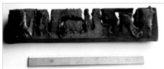
Рис. 2. Типичные резы при резке под различным углом стального листа толщиной 30 мм полуавтоматом ПШ107Р
