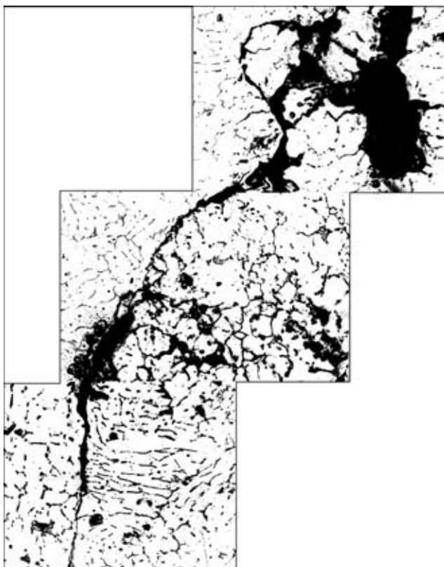
Рис. 10. Микроструктура ( \times 200 ) слитка сплава АМц с оксидными пленками и несплошностями (расстояние от поверхности слитка составляет приблизительно 10 мм)
