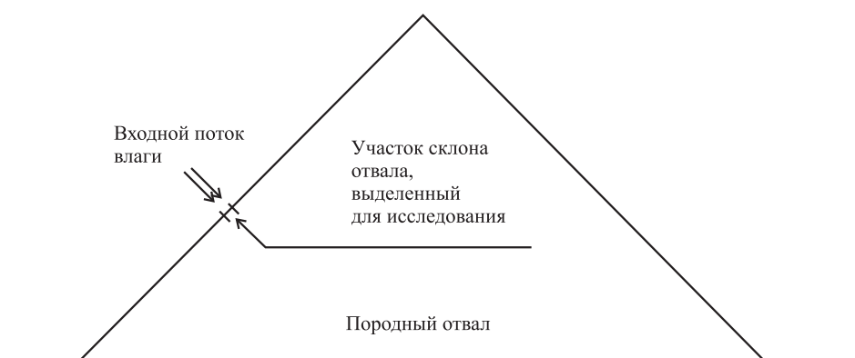
Рис. 1. Схема отвала с исследуемым участком на поверхности склона.
