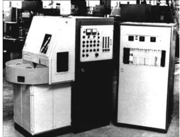
Рис. 12. Автоматическая установка УП142 для наплавки деталей арматуры
