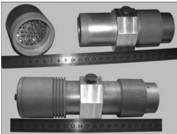
Рис. 3. Излучательный блок на основе СД-матрицы
