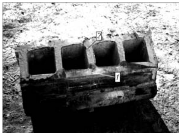
Рис. 3. Внешний вид поверхности раздела (разрушения) подвижной щеки дробилки: 1 — участок с усталостным разрушением; 2 — участок с хрупким разрушением
