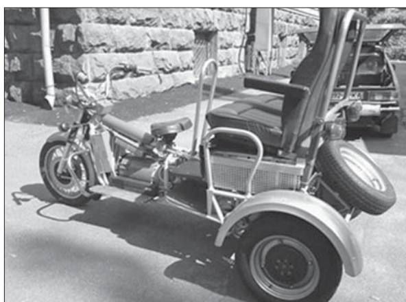
Рис. 4. Гібридний вантажопасажирський електромобіль та прототип електроцикла
