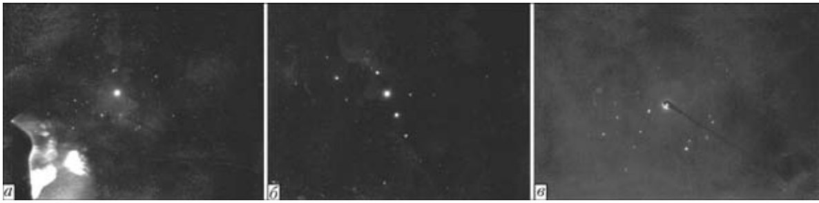
Рис. 6. Дифракционные картины ( \times 55000 ) матрицы (а), карбидной фазы (б) и структуры зерен (в) металла швов, выполненных сваркой под водой
