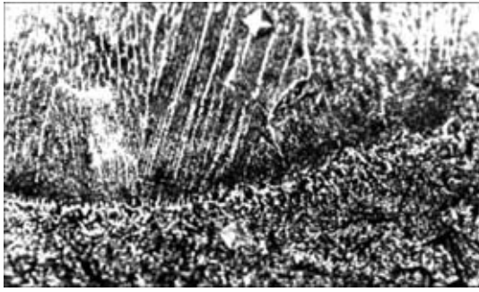
Рис. 12. Микроструктура зоны плавления на поверхности образца, обработанного по режиму 3 (см. рис. 10), \times 400
