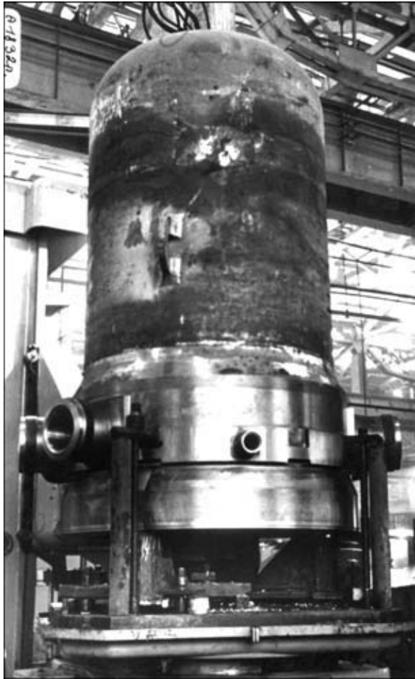
Рис. 4. Штамповварной корпус транспортного атомного энергетического реактора биметаллического проката 18X2МА + 00X18Н10Т в стенде после окончательной механической обработки
