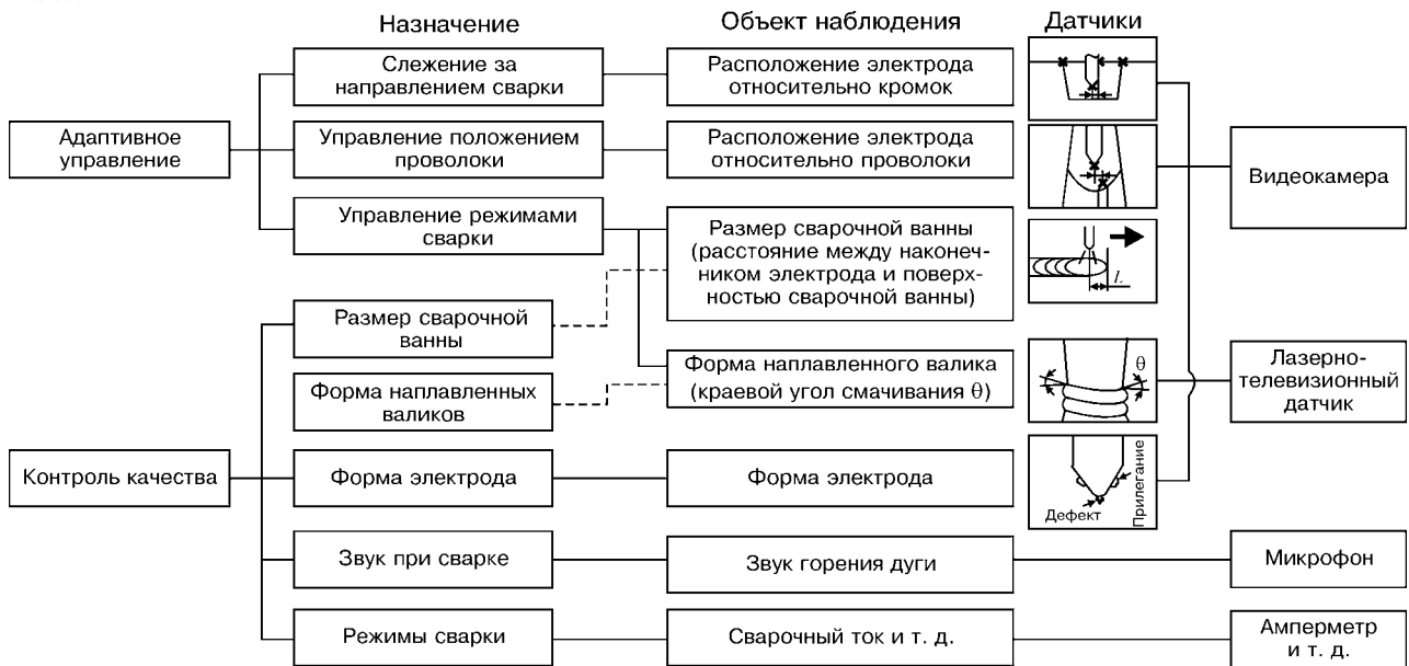
Рис. 4. Функция контроля качества шва и датчики установки для сварки во всех пространственных положениях
