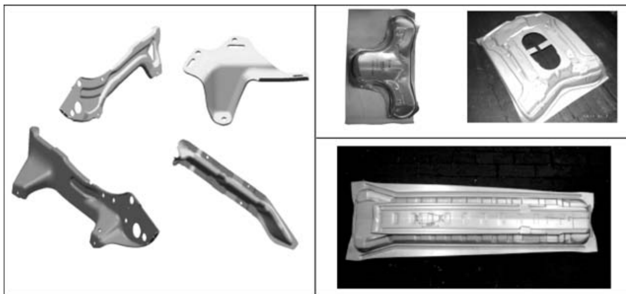
Рис. 5. Детали элементов кресел и кузовов легковых автомобилей, изготовленные трехмерной лазерной резкой (материал — сталь для глубокой вытяжки, оцинкованная и углеродистая сталь толщиной 0,8... 3,0 мм)
