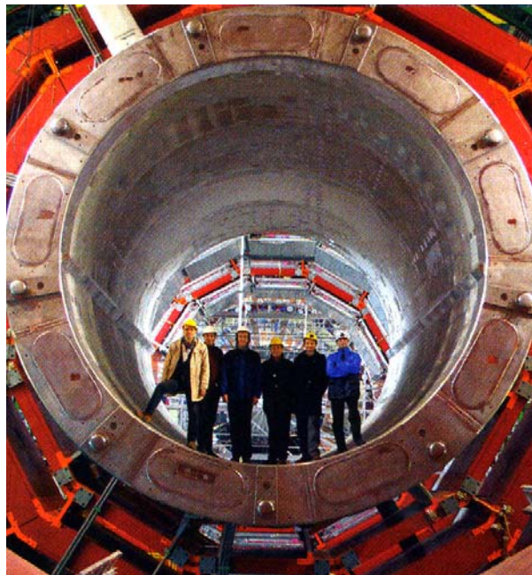
Рис.7. Сверхпроводящий соленоид (весом 224 т, включая около 15 т Nb-Ti сверхпроводящего кабеля) для детекторов частиц Большого адронного коллайдера
