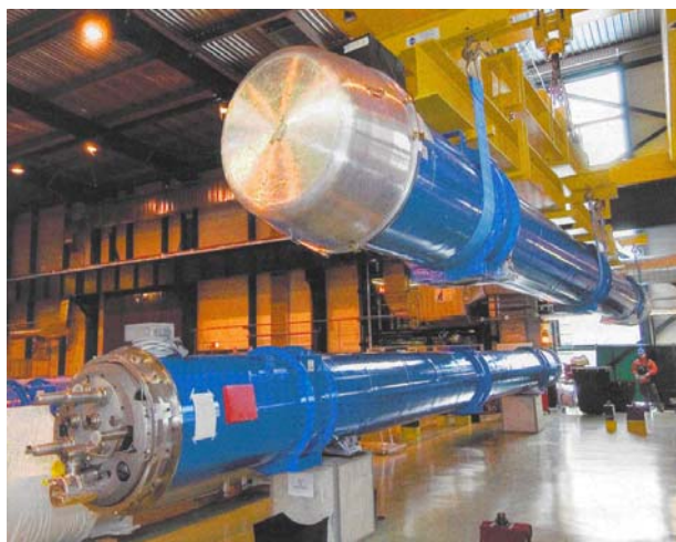
Рис.6. Два из 1232 сверхпроводящих дипольных магнита (длиной по 15 м и весом 35 т каждый) для Большого адронного коллайдера ЦЕРН
