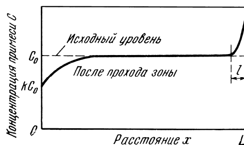
Рис. 1. Изменение концентрации примеси после прохода зоны шириной l для k < 1
