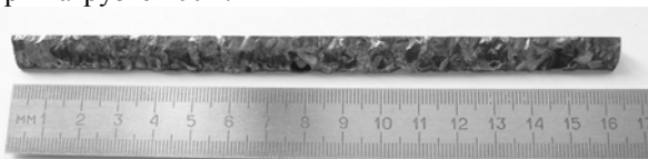
Рис. 4. Общий вид образца гафния, подготовленного для рафинирования методом зонной плавки
