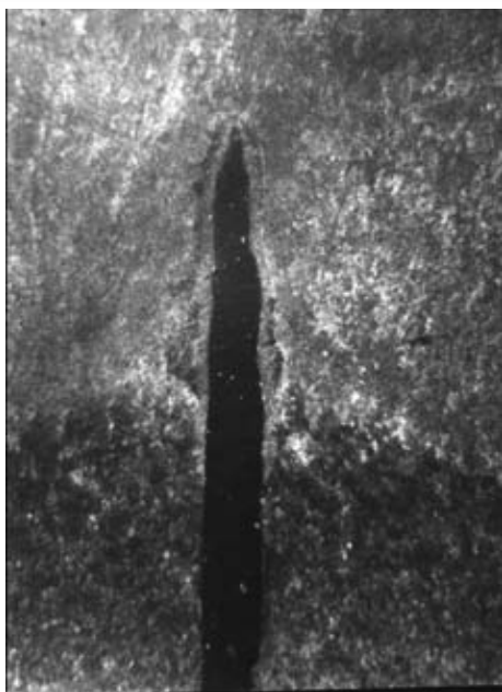
Рис. 2. Макрошлиф наплавки с тугоплавкой вставкой
