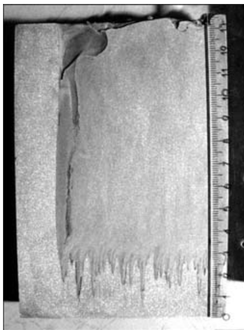
Рис. 3. Продольный макрошлиф образца из низколегированной стали 12CrMoV, выполненный равномерно движущимся со скоростью v = 5 мм/с электронным лучом (в нижней части шва видны пики глубины проплавления и корневые дефекты)
