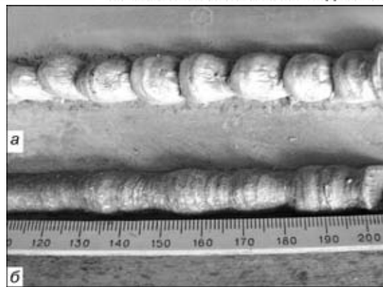
Рис. 4. Возмущения (вид сверху), возникающие на поверхности шва алюминиевого сплава при ЭЛС в нижнем положении со скоростью 4 мм/с: а — статическим электронным лучом; б — использованием развертки электронного луча ( f_1 = 180 Гц)
