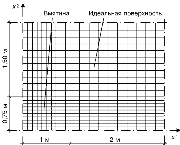
Рис. 2. Разностная сетка цилиндрической оболочки стенки резервуара радиусом r = 19950 мм с вмятиной прямоугольного очертания
