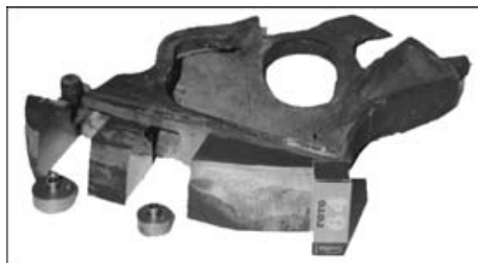
Отремонтированный замок и образцы для механических испытаний, изготовленные из вырезанных частей его заплакированной зоны
