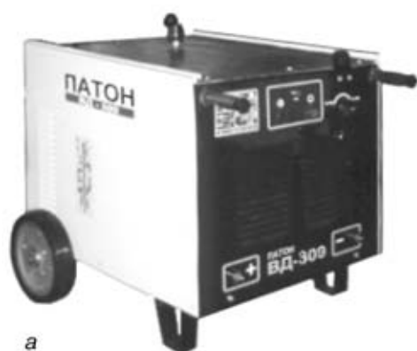
Рис. 2. Внешний вид выпрямителя ВД-309 (а); вольт-амперная характеристика вспомогательного (1) и рабочего (2) выпрямителя (б)
