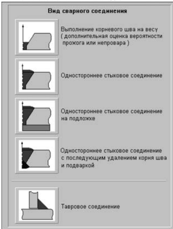
Рис. 3. Виды сварных соединений, предлагаемых пользователю
