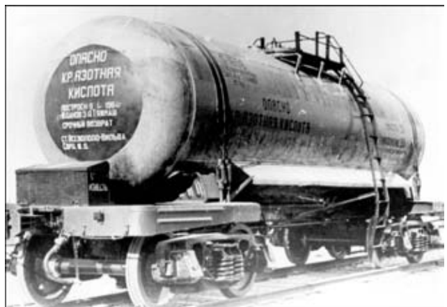
Рис. 4. Железнодорожная цистерна для перевозки химических агрессивных продуктов
