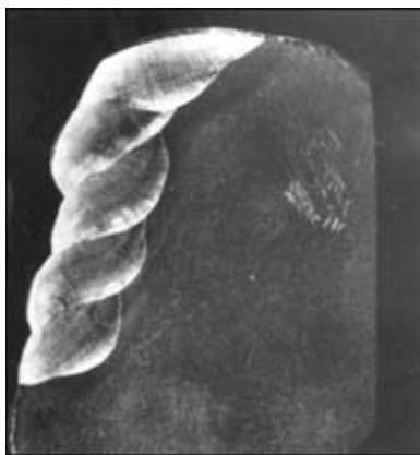
Рис. 1. Макрошлиф наплавленной губы рельса
