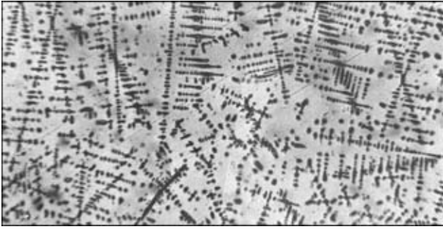
Рис. 3. Микроструктура наплавленной бронзы Бр.АЖ9-4 (X200)
