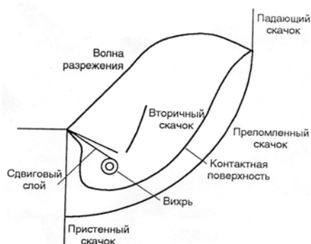
Рис. 5 – Схема течения при дифракции ударной волны на обратном уступе в газах
