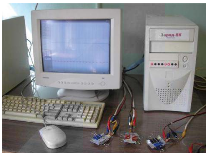
Рис. 5. Стенд «Заряд-8К» в процессе испытания пакетных СК.
