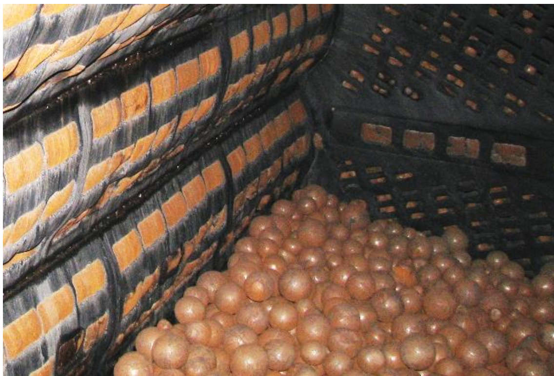
Рис. 6.5 – Резиновая футеровка «G.M-волна»; СевГЭК, мельница \varnothing 3,6 м, первая стадия измельчения, шары \varnothing 100 мм, t = 6,5 мес.
