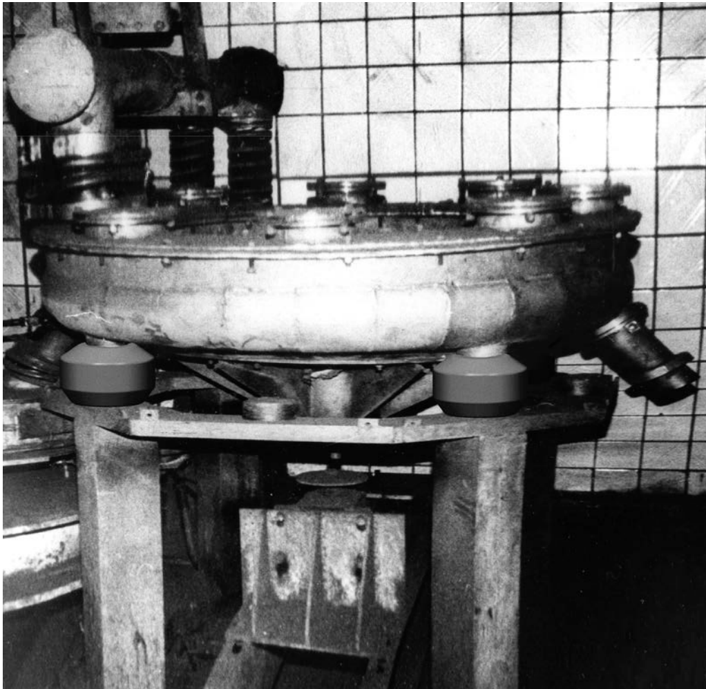
Рис. 6.4.3 – Узел смешения и гранулирования (виброизоляторы типа ВР)
