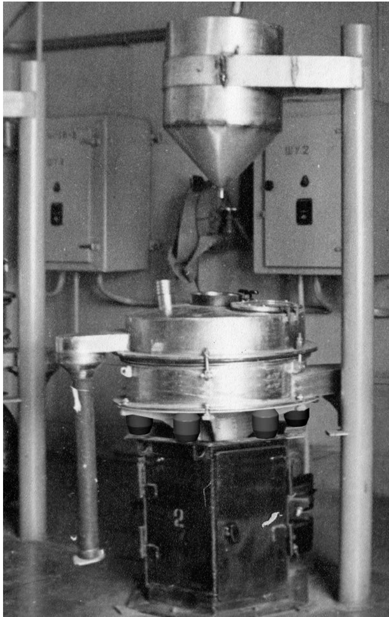
Рис. 6.4.5 – Вибрационное сито СВ-06 (виброизоляторы типа ВР)
