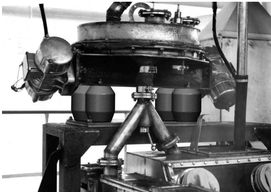
Рис. 6.4.6 – Вибрационное сито (виброизоляторы типа ВР)
