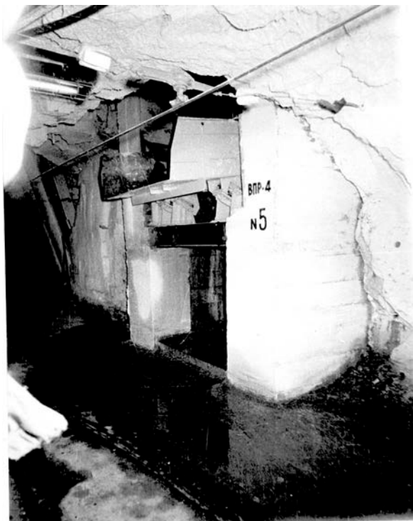
Рис. 6.2.5 – Вибрационный питатель ВПР-4 в шахте при добыче урановой руды
