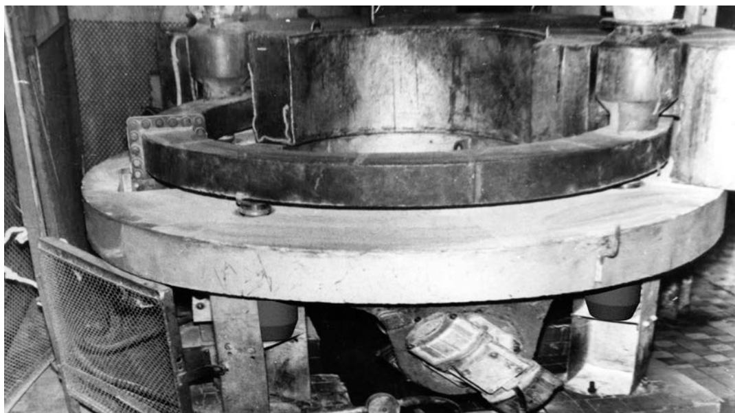
Рис. 6.5.3 – Вибрационная печь ВП-0,07-567 с виброизоляторами ВР
