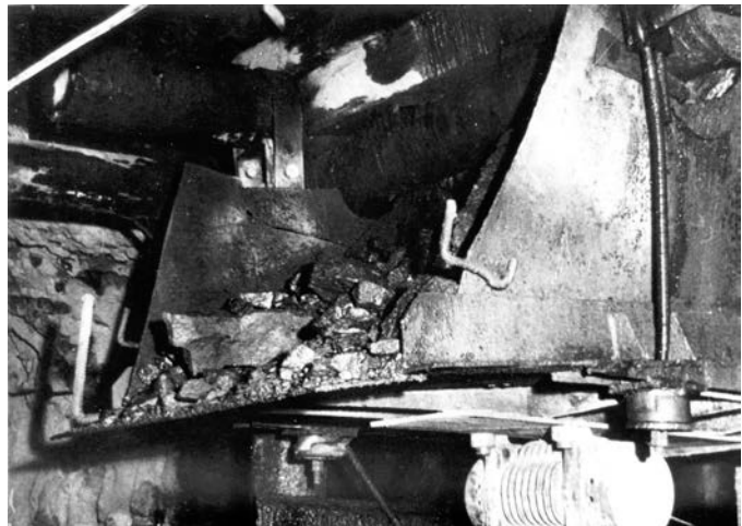
Рис. 6.2.6 – Вибрационный питатель типа ПВМ с цилиндрическими упругими элементами в шахте при добыче урановой руды
