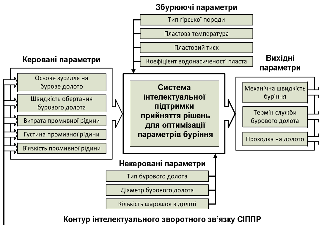
Рисунок 2 – Структурна схема моделі прийняття оптимальних рішень в процесі буріння нафтових і газових свердловин роторним способом
