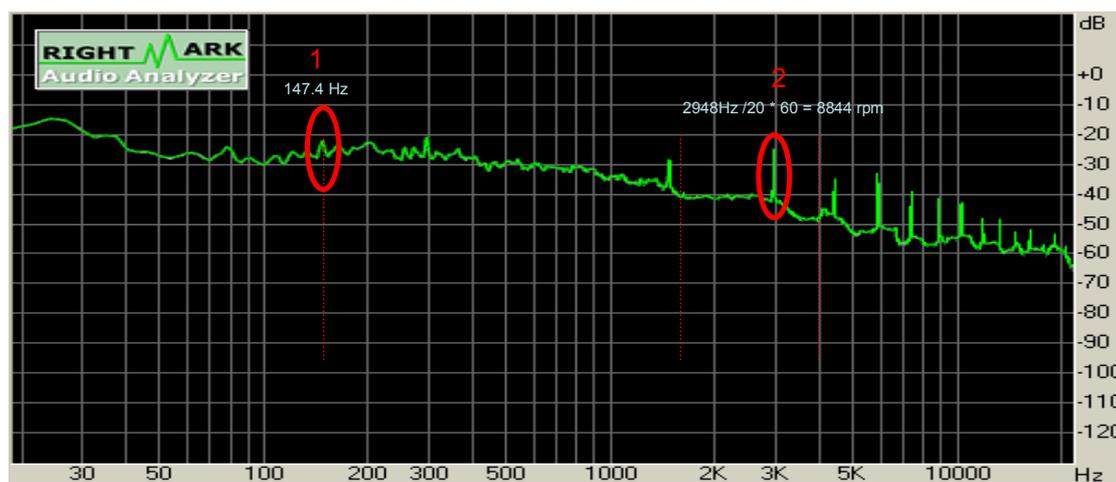
Рисунок 1 – Спектр виброакустического сигнала ГТН VTR-350
