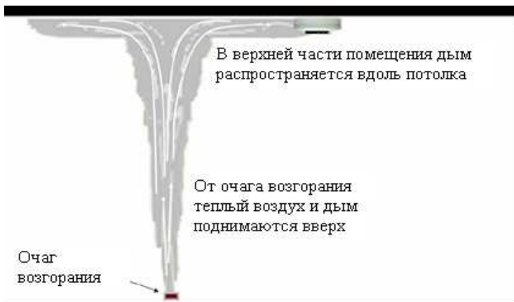
Рис. 4. Распространение теплого воздуха и дыма
