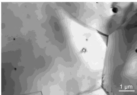
Рис. 1. Исходная структура стали SS316 после термической обработки при 1340 К/0,5 ч
