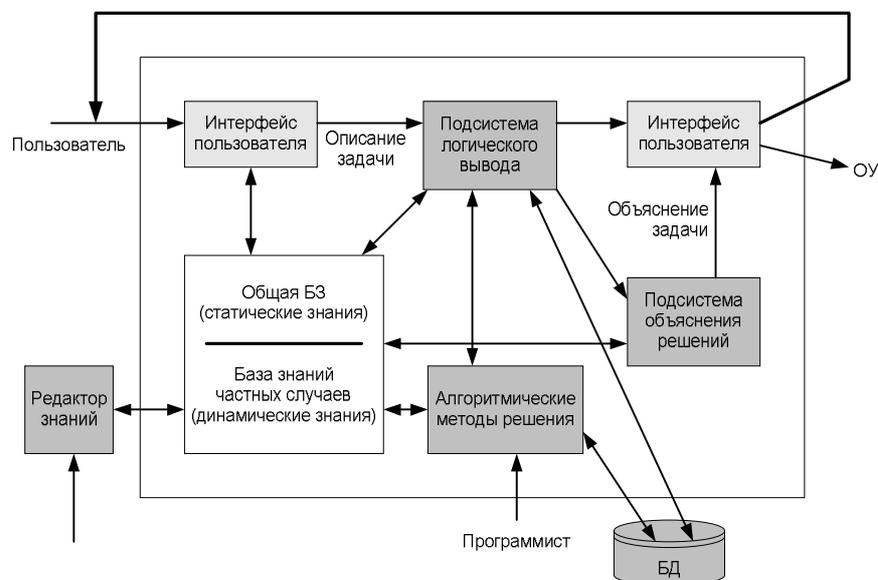
Рисунок 1 – Структура экспертной системы
