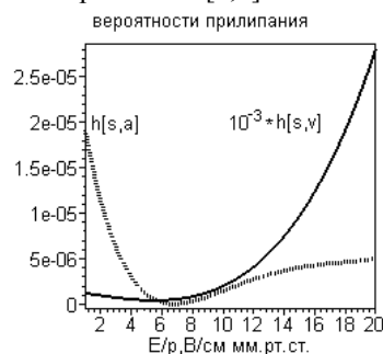
Рис.1. Зависимости вероятностей прилипания электронов в сухом воздухе (слева) и паров воды (справа)
