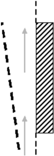
Рис.2 Плавне настилення повітряного потоку на поверхню експонату
