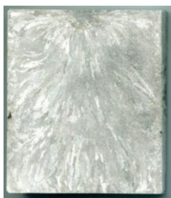
Рис. 5. Макроструктура слитка стали 08X18H10T с 0,02 вес.% ZrO 2 +Y 2 O 3
