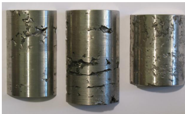
Рис. 4. Слитки стали 08X18H10T ВДП с концентрацией добавки ZrO_2+Y_2O_3 0,02 и 0,2 вес.% и слиток без добавок
