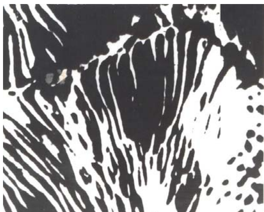
Рис. 6. Микроструктура композита Mo-Zr-C, продольное сечение. X 600 . R = 1,6 \cdot 10^{-5} м/с
