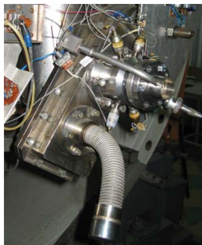
Рис. 9. Мишенный комплекс, установленный на ускорителе
