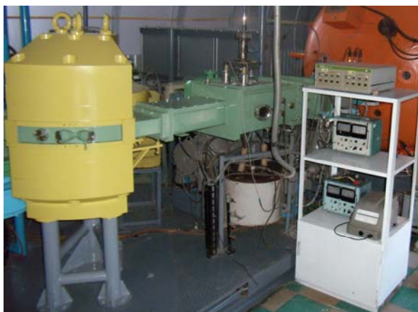
Рис. 5. Общий вид электромагнитного сепаратора масс, системы формирования и фокусирования пучка ионов
