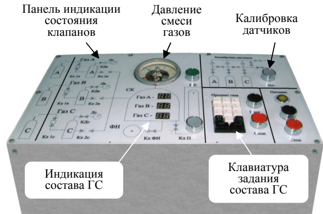
Рис. 5. Панель управления ГТС
