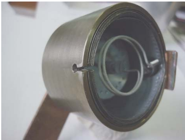
Рис. 1. Сублимационный источник, изогнутый в виде двухвитковой спирали
