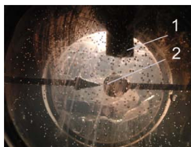
Рис. 2. Общий вид зоны генерации акустических импульсов: 1 – ствол пневмоакустического Излучателя; 2 – межэлектродный промежуток (МЭП)
