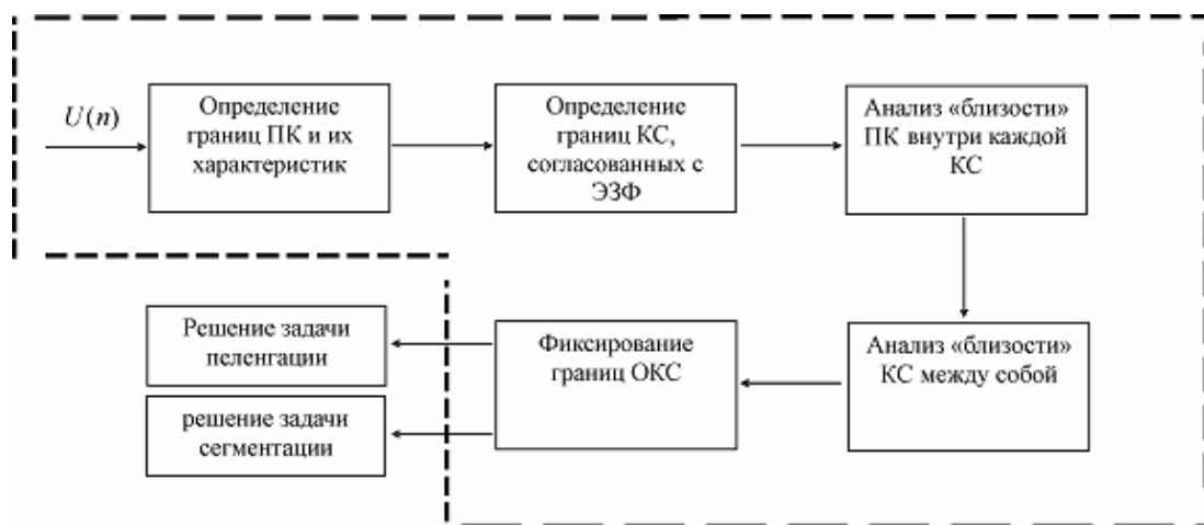
Рисунок 6 – Структурная схема алгоритма решения задачи автоматического определения границ текущих ОИ
