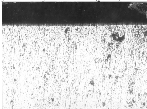
Рис.9. Структура оксидной пленки, сформировавшейся на йодидном цирконии (отжиг при 560\text{ }^\circ\text{C} 3 ч) после испытаний в течение 23 тыс. ч в потоке кислородсодержащей ( C_{O_2} = 20...30 мг/кг) пароводяной смеси ( 350\text{ }^\circ\text{C} ) x 500
