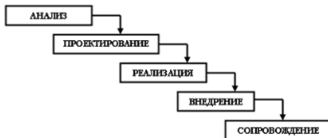
Рисунок 1 – «Водопадная» или «каскадная» модель процесса разработки
