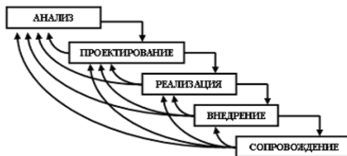
Рисунок 2 – Модель «водоворота» или «возвратная» модель процесса разработки
