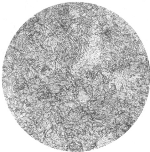
Рис. 3. Микроструктура металла ГЦТ после 100 \cdot 10^3 ч эксплуатации. Увеличение 500
