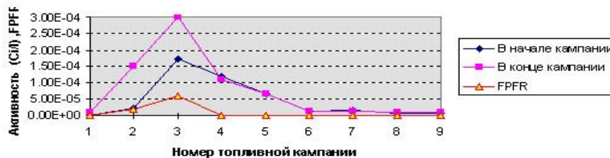
Рис. 6. Изменение активности теплоносителя по изотопам йода и доли негерметичных ТВЭЛ для энергоблока № 5 ЗАС
