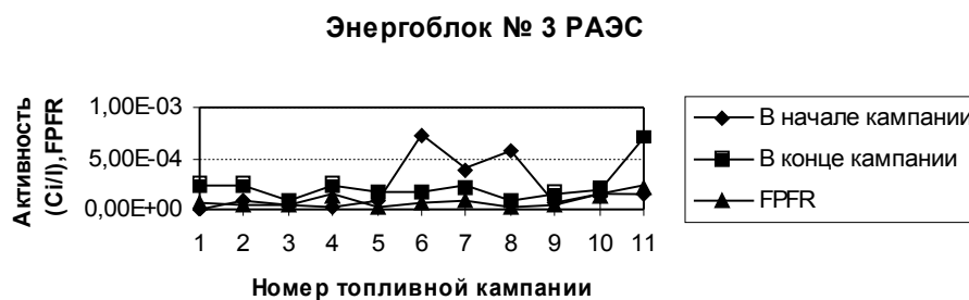
Рис. 8. Изменение активности теплоносителя по изотопам йода и доли негерметичных ТВЭЛ для энергоблока № 3 РАЭС
