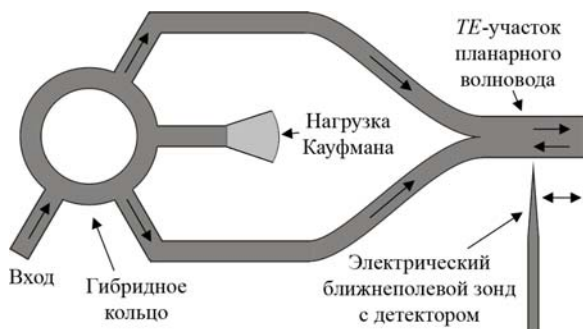
Рис. 3. Схема экспериментальной ячейки, используемой для возбуждения моды HE_{10} и измерения ее длины волны
